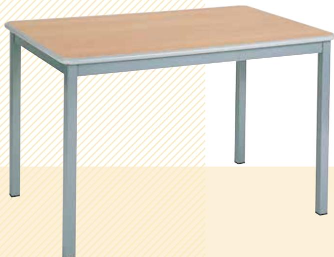
› Telaio sottopiano in tubo di acciaio rettangolare 50x20 mm e gambe 40x40 mm oppure Ø 50 mm. Verniciatura a polveri termoindurenti nei colori di serie o a richiesta altri colori.
