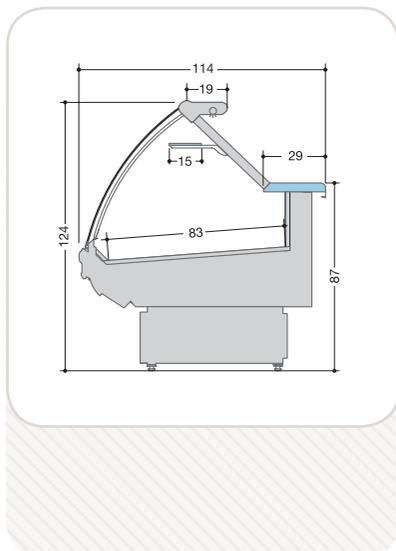
Banco neutro per pane, vetri curvi apribili a pistoncini, una mensola intermedia non refrigerata cappello in alluminio, esposizione da 83cm, spalle in termoformato da 5,5cm, pannello frontale personalizzabile in 5 finiture, parapolvere frontale.
