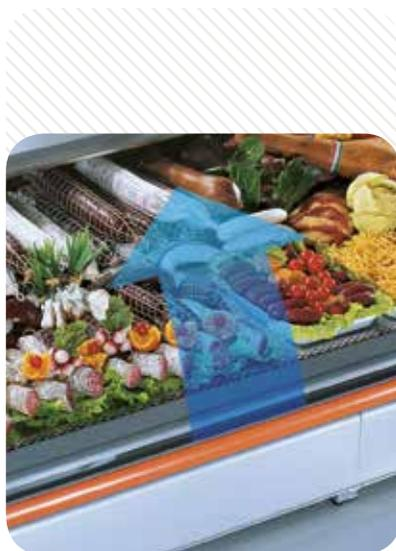
Banco con refrigerazione ventilata, gruppo incorporato, riserva refrigerata a sportelli, vetrina a montanti posteriori con vetri curvi apribili a pistoni, piano lavoro in acciaio inox, cappello in alluminio, piano esposizione da 90cm in acciaio inox, quadro elettronico, spalle in termoformato da 5,5cm, pannello frontale in lamiera plastificata personalizzabile in 5 finiture.
