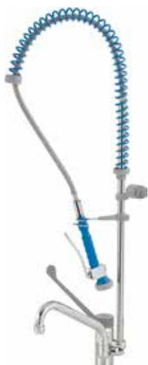
► Gruppo doccia con monocomando da banco "STYL". Gambo di fissaggio filettato G 3/4 lungo 50 mm. Cartuccia miscelatrice ad alta portata. con canna girevole in tubo d'ottone ø 25. Allacciamento idrico: tubetti rigidi in rame nichelato ø 10x1 con raccordi filettati maschio G 1/2 (ISO 228-1). I gruppi doccia sono forniti completi di valvole di non ritorno. Portata d'acqua: 16 l/min (testa doccia) Portata d'acqua: 20 l/min (canna girevole)
