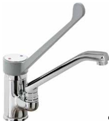
► Monocomando da banco "STYL" con canna girevole fusa in ottone. Portata = 14 l/min. Diametro del foro per l'installazione: 35 mm. Allacciamento idrico: flessibili con raccordi filettati femmina G 1/2 (ISO 228-1). Portata d'acqua: 14 l/min.
