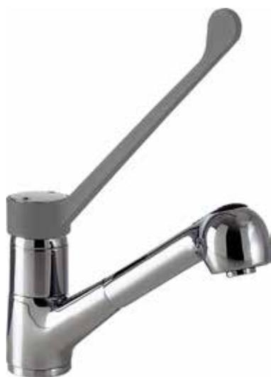
► Monocomando da banco "STYL" con doccetta estraibile. Diametro del foro per l'installazione: 35 mm. Allacciamento idrico: tubetti con raccordi filettati femmina G 1/2 (ISO 228-1). Portata d'acqua: 14 l/min.
